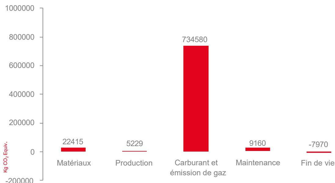
La consommation de carburant et les émissions de gaz qui en résultent constituent le principal facteur affectant le réchauffement climatique. C'est pourquoi Renault Trucks fait de l'efficacité énergétique un des axes fondamentaux du développement de ses produits.
