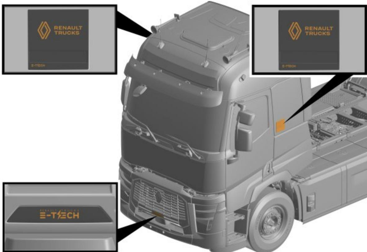
Um BEV (Veículo elétrico a baterias) é identificado pelo emblema 'E-TECH' localizado na dianteira da cabina e junto às portas da cabina dos dois lados.
