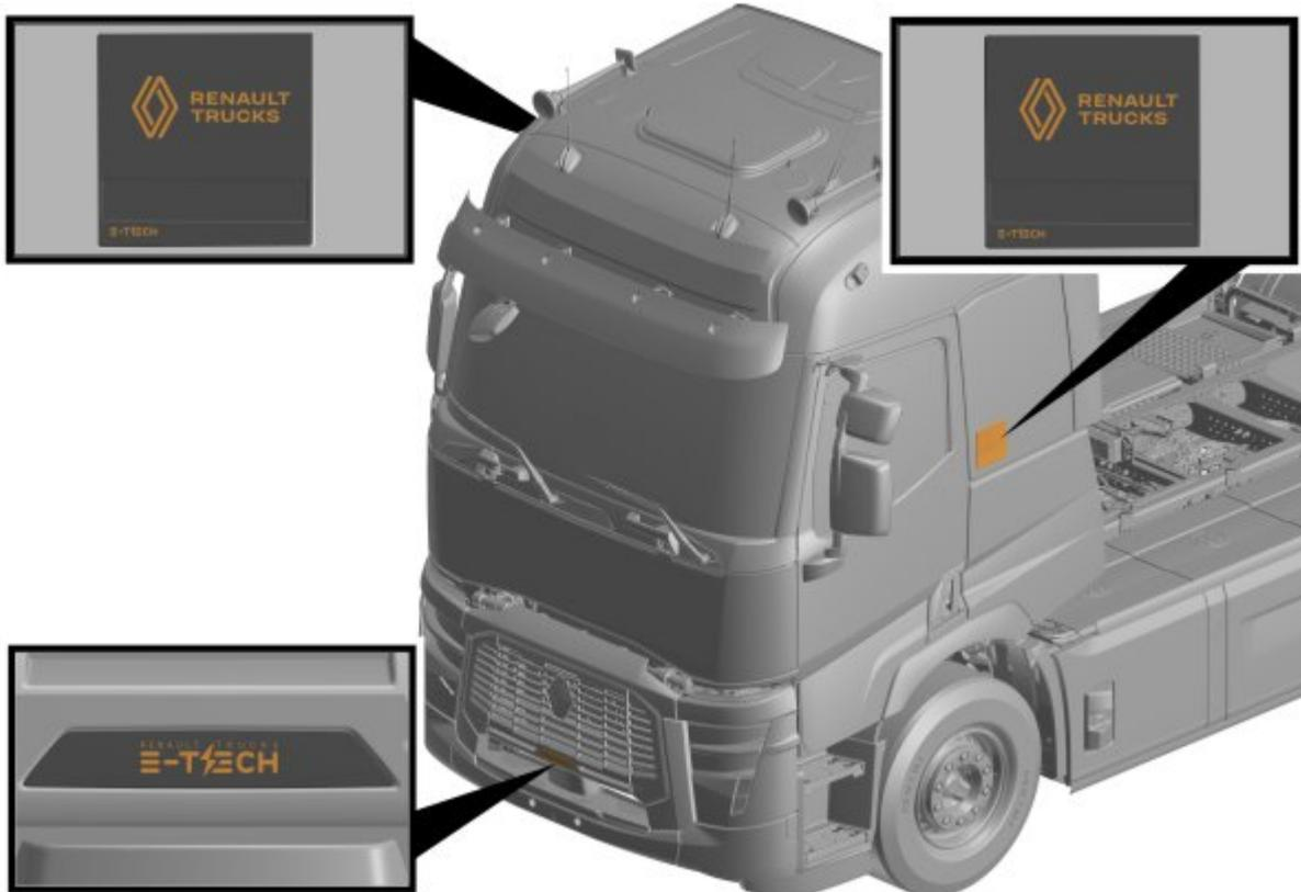
Un BEV (Veicolo elettrico a batterie) è identificato dall'emblema 'E-TECH' posizionato sulla parte anteriore della cabina e vicino alle porte della cabina su entrambi i lati.
