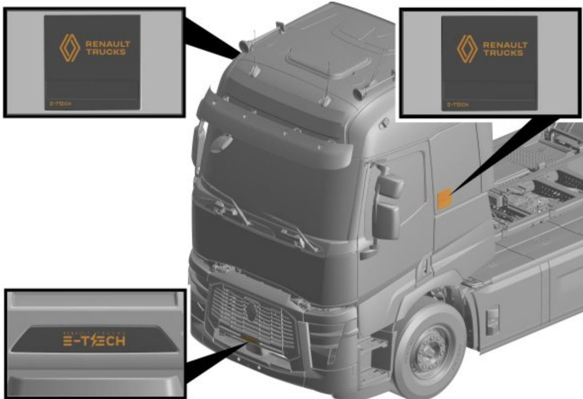
Un BEV (Véhicule électrique à batterie) est identifié par l'emblème 'E-TECH' situé sur l'avant de la cabine et à proximité des portes de cabine des deux côtés.
