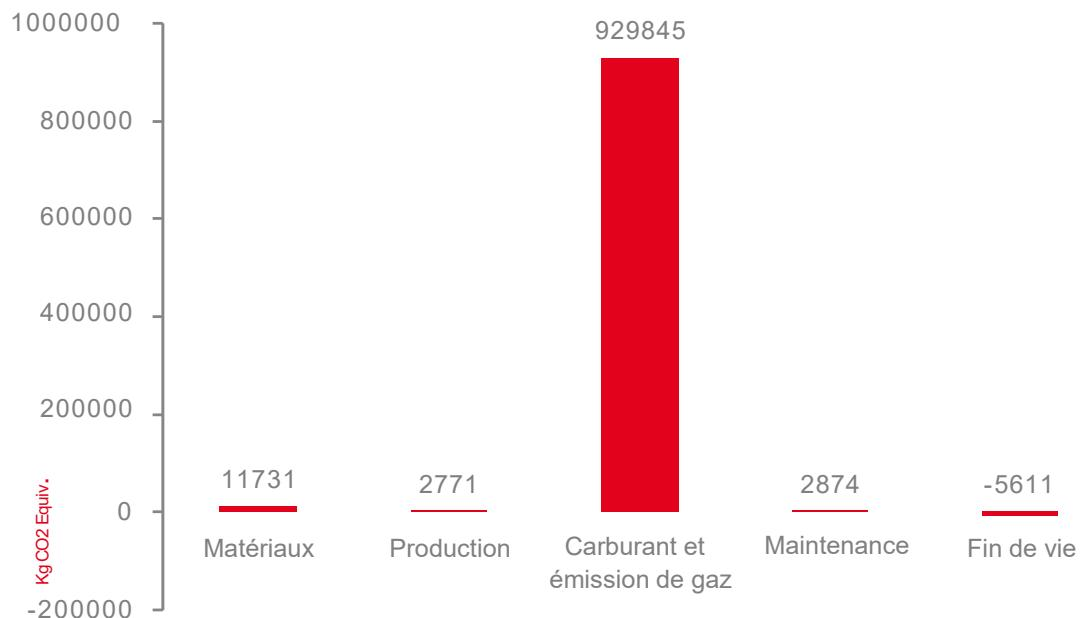
La consommation de carburant et les émissions de gaz qui en résultent constituent le principal facteur affectant le réchauffement climatique. C'est pourquoi Renault Trucks fait de l'efficience énergétique un des axes fondamentaux du développement de ses produits.
