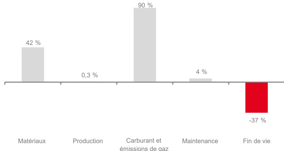
La consommation de carburant et les émissions de gaz qui en résultent constituent l'essentiel de l'impact. Les matériaux utilisés pour la construction du véhicule et notamment ceux introduits pour répondre à la norme Euro VI ont une part significative cependant compensée par leur taux élevé de recyclage.
