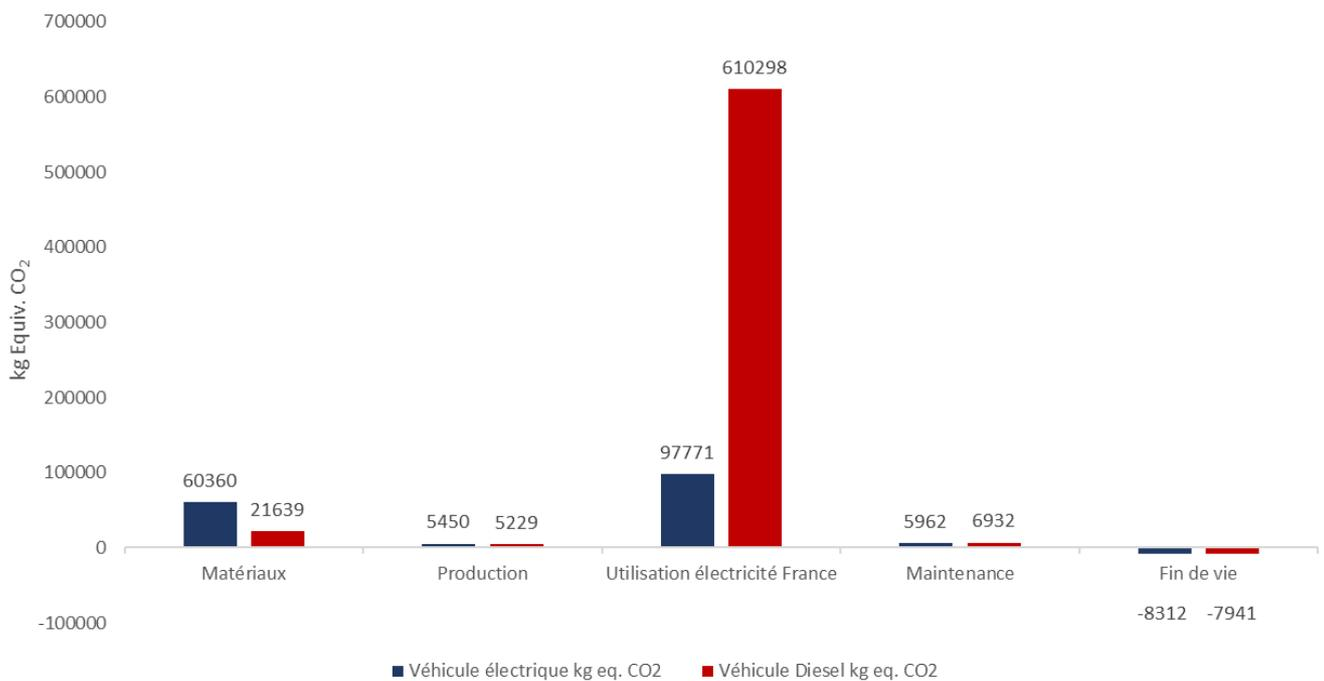
Potentiel de réchauffement global pour les cycles de vie du Renault Trucks E-Tech T porteur 6x2.
