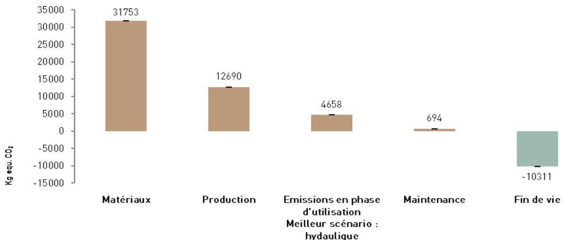
Potentiel de réchauffement global pour les cycles de vie du Renault Trucks E-Tech D WIDE. Les émissions en phase d'utilisation font apparaître le meilleur scénario.
