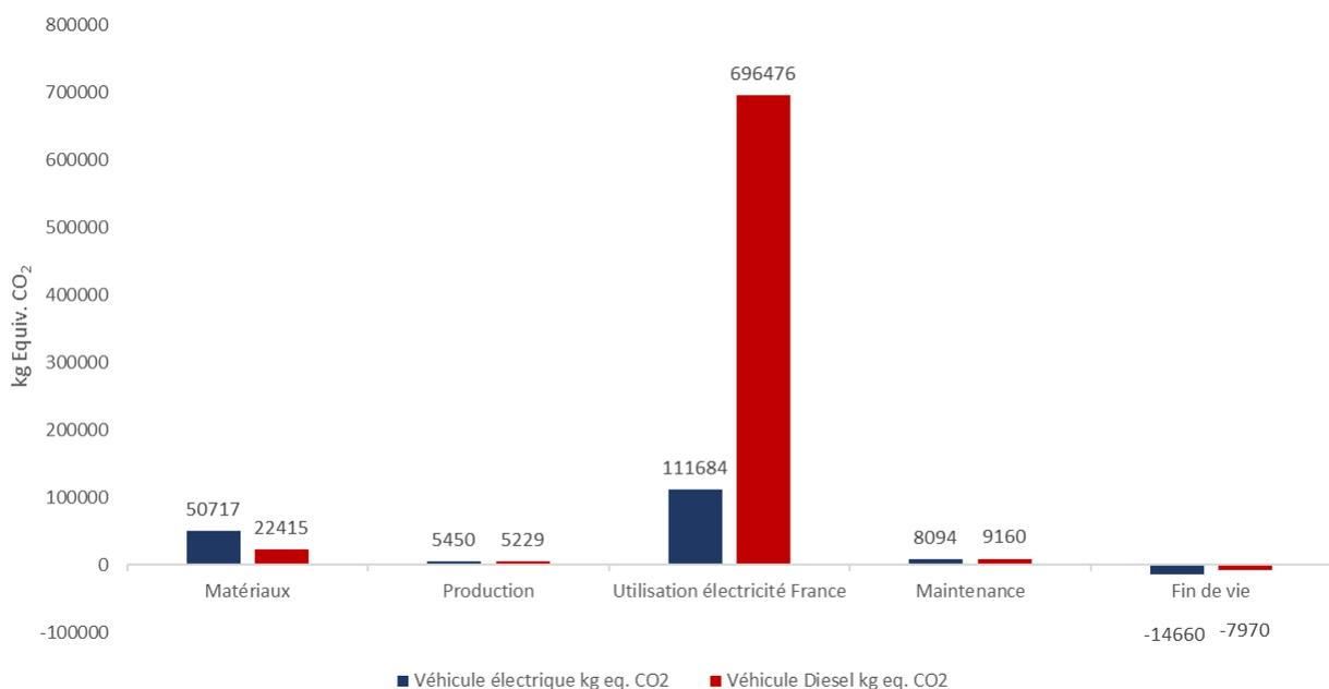
Potentiel de réchauffement global pour les cycles de vie du Renault Trucks E-Tech C porteur 8x4.
