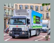
Aux modèles Renault Trucks E-Tech D et D Wide de 16 et 26 tonnes, produits en série, s'est ajouté un E-Tech D Wide adapté aux missions de distribution sous température dirigée.
