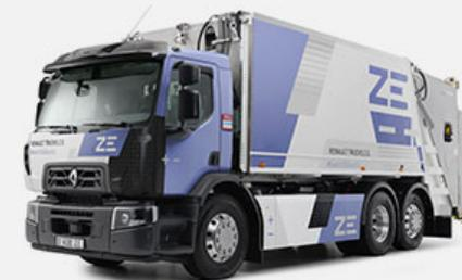
5 configurations de batteries, allant jusqu'à 6 packs de batteries de 66 kWh pour une autonomie pouvant atteindre 400 km.
