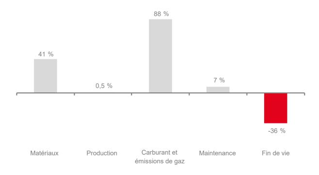
La consommation de carburant et les émissions de gaz qui en résultent constituent l'essentiel de l'impact. Les matériaux utilisés pour la construction du véhicule et notamment ceux introduits pour répondre à la norme Euro VI ont une part significative cependant compensée par leur taux élevé de recyclage.
